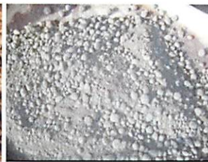
残りコンクリートの造粒固化
